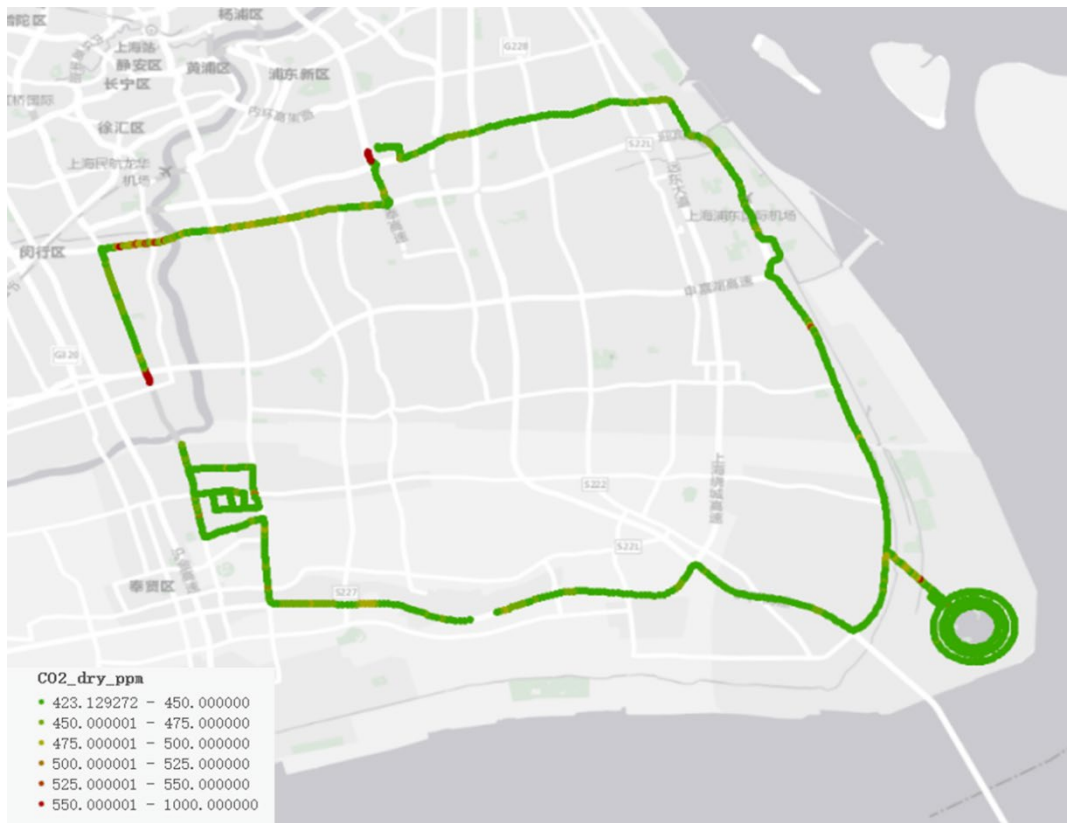
图7 上海市走航监测的二氧化碳空间分布（腔增强吸收光谱技术）
